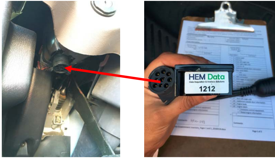
Figure 3-2. J1939 Mini Logger™ used in this project
