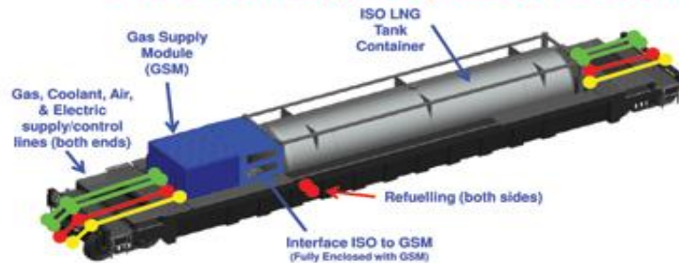
LNG Container Tender LNG and NG Equipment Layout
