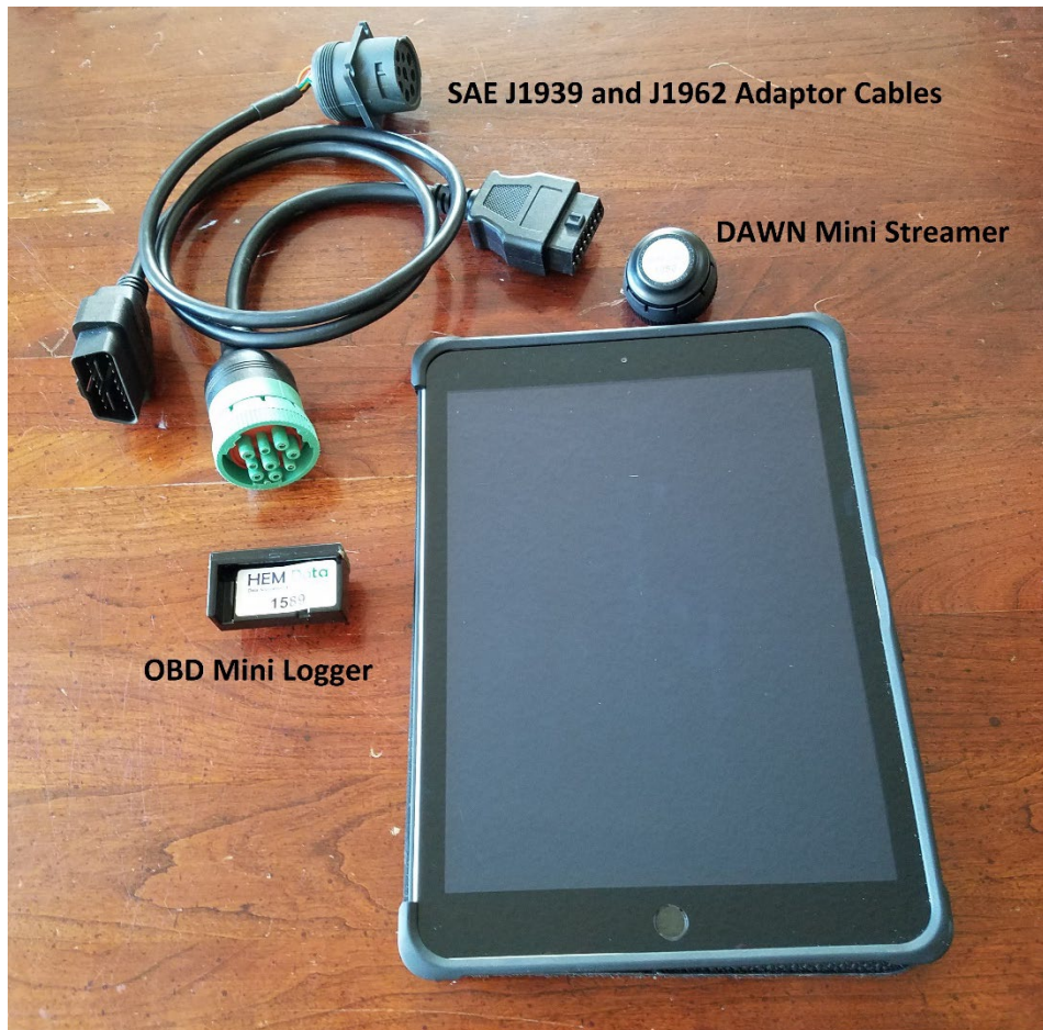
Figure 2-3 HEM Data OBD Mini Logger and DAWN Mini Streamer
