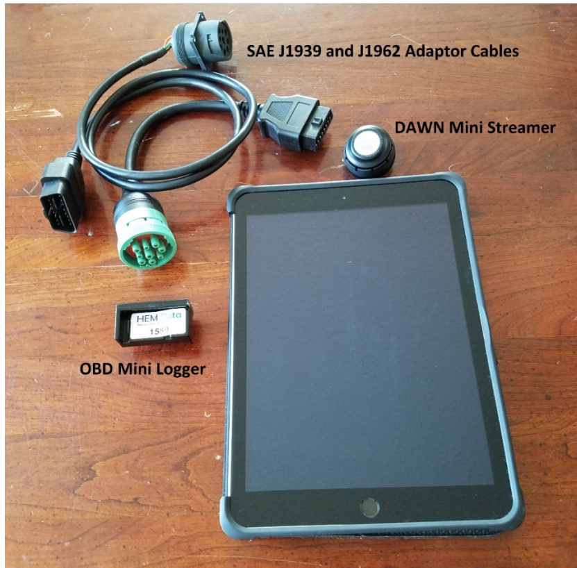
Figure 3-2. HEM OBD Mini Logger and DAWN Mini Streamer.
