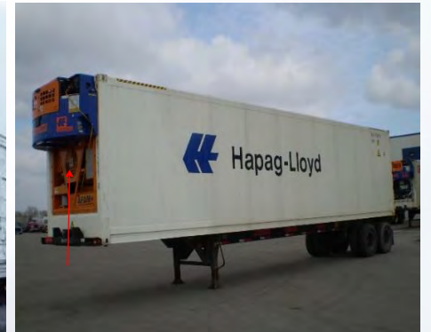
TRU Generator Set
