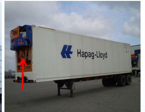
TRU Generator Set
