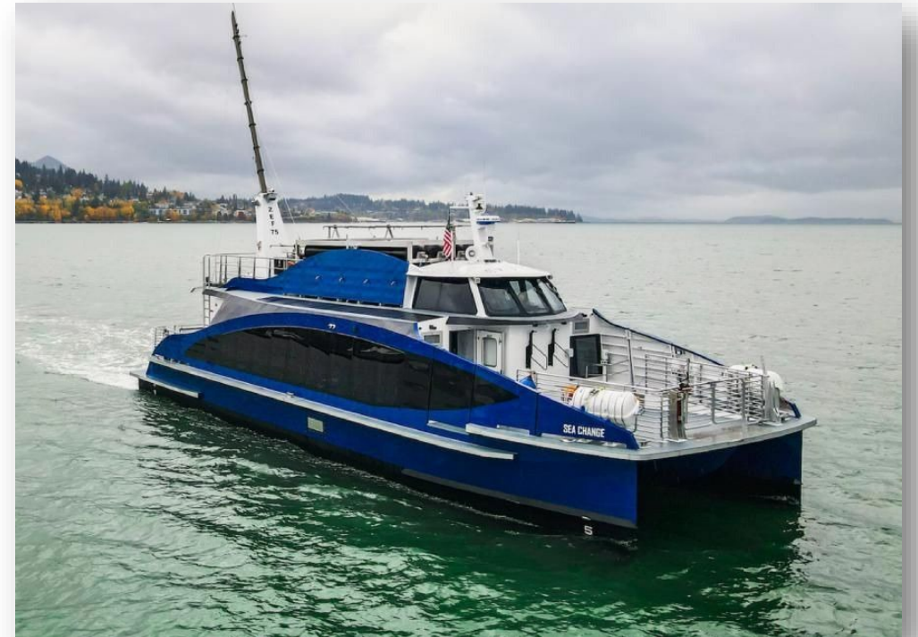
SEA CHANGE, transbordador de pasajeros de pila de combustible de hidrógeno. Fuente: SWITCH Maritime
