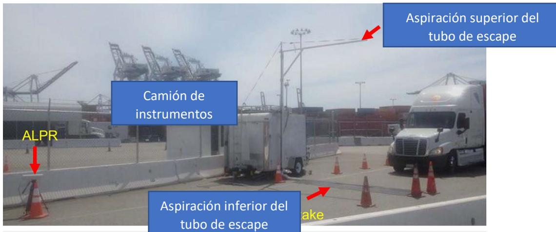
Figura 1. Instalación de PEAQS en el Puerto de Los Angeles.
