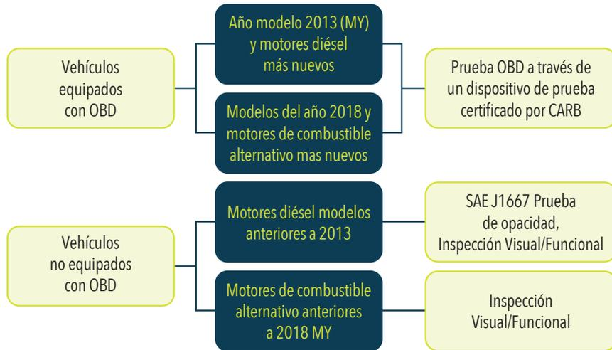
La prueba se puede realizar en cualquier lugar utilizando el sistema OBD del camión, siempre y cuando sea un evaluador acreditado por CARB que utilice un dispositivo de lectura certificado por CARB. Cuando se envíen los datos de pruebas y reportes utilizando dispositivos telemáticos que han recibido la certificación CARB, no se requiere un evaluador acreditado por CARB.
