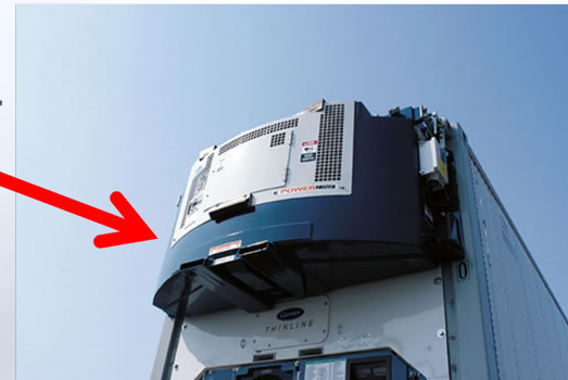
TRU Generator Set
