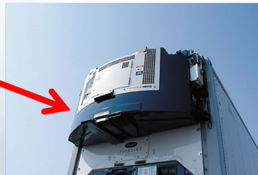
TRU Generator Set
